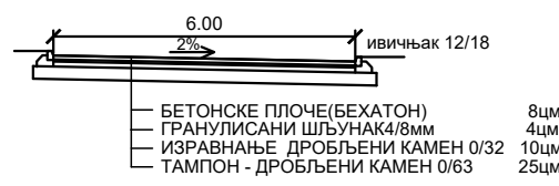
КАРАКТЕРИСТИЧАН ПОПРЕЧНИ ПРОФИЛ ПРИСТУПНЕ САОБРАЋАЈНИЦЕ И РАМПЕ
